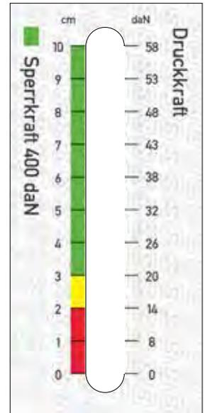
Sperr- und Klemmkraftkontrolle durch patentierte Kraftanzeige mittels Farb- und daN-Skala.
