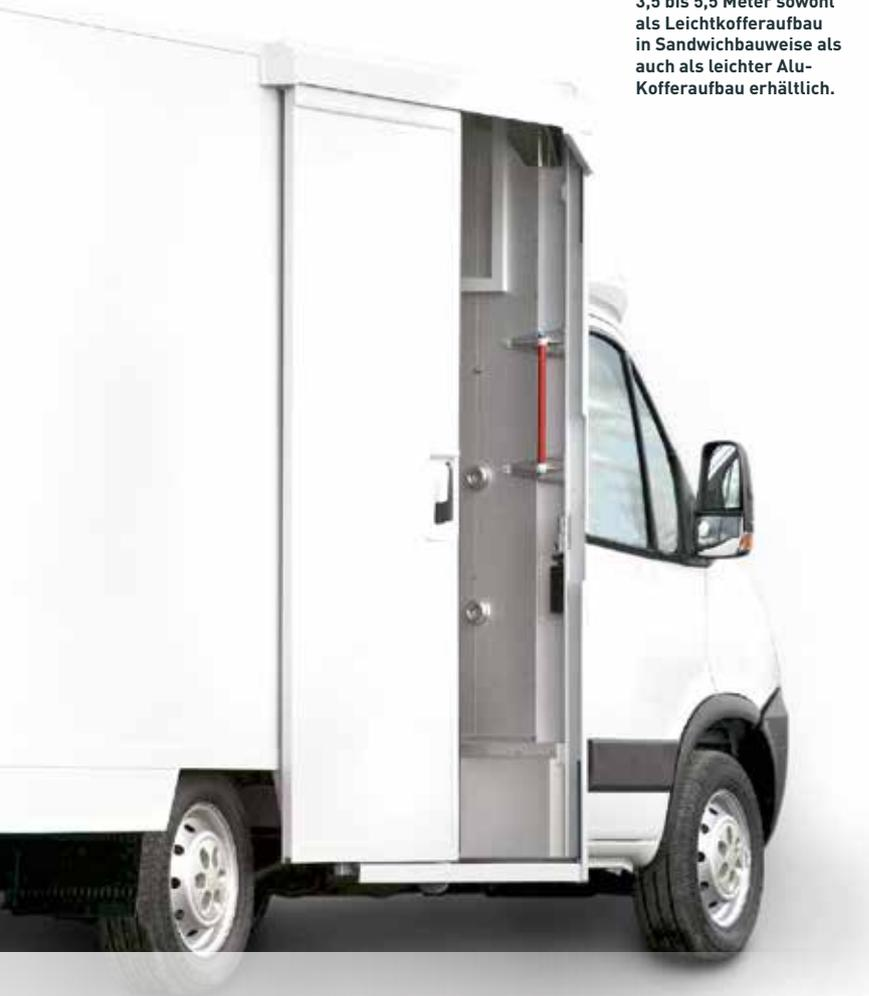
Der SOMMER TI ist in vier verschiedenen Längen von 3,5 bis 5,5 Meter sowohl als Leichtkofferaufbau in Sandwichbauweise als auch als leichter Alu-Kofferaufbau erhältlich.
