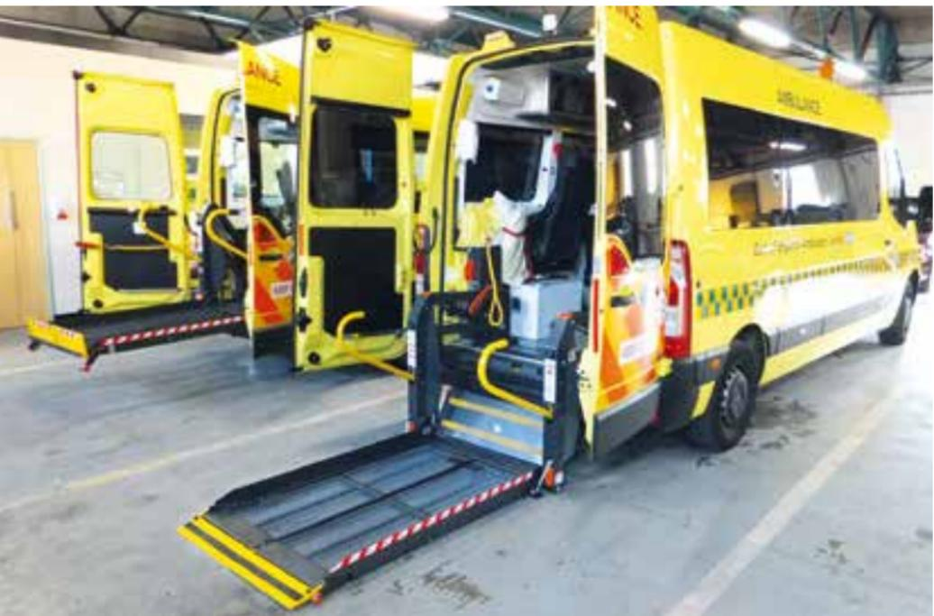
Der verstärkte Linear-Lift mit 2-Hubarmen bietet 500 kg Hubkraft und erfüllt die Anforderungen der anspruchsvollsten Bereiche der Personenbeförderung. Die Plattform Länge kann bis 1600 mm gefertigt werden, um das Be- und Entladen von Rolltragen zu ermöglichen. Die Plattformbreite kann mit 920 mm gewählt werden, um breitere Rollstühle und Rolltragen zu heben.
