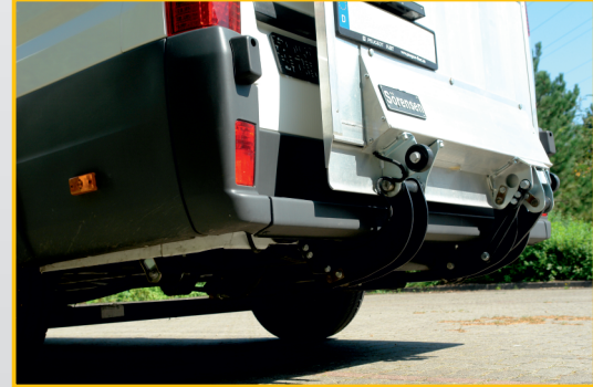
Mit der größten Bodenfreiheit ihrer Klasse: Die X1A 600E mit 600 kg Tragkraft
