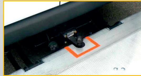
Ladebordwandbetrieb auch mit montierter Anhängerkupplung möglich.
